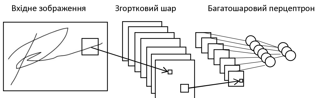
Рис. 3. Структура Згорткової нейронної мережі.
