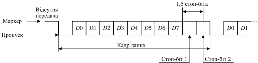
Рис. 3.26. Формат кадру даних під час асинхронної передачі даних
